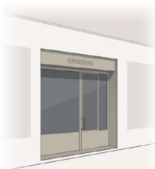
*Schéma de devanture en feuillure destiné à illustrer le contenu réglementaire, il ne peut en aucun cas s'y substituer.*
